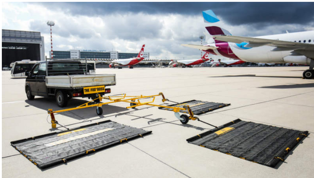
Fot.8. Maty ciągnięte przez samochody, służące do zbierania FOD, źródło : ze zbiorów autora
