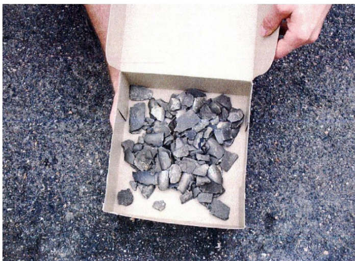
Fot.3. Części silnika znalezione przez służby lotniskowe na RWY 22R. W tle powierzchnia drogi startowej. Źródło: Raport C5/2010L fińskiego Accident Investigation Board
