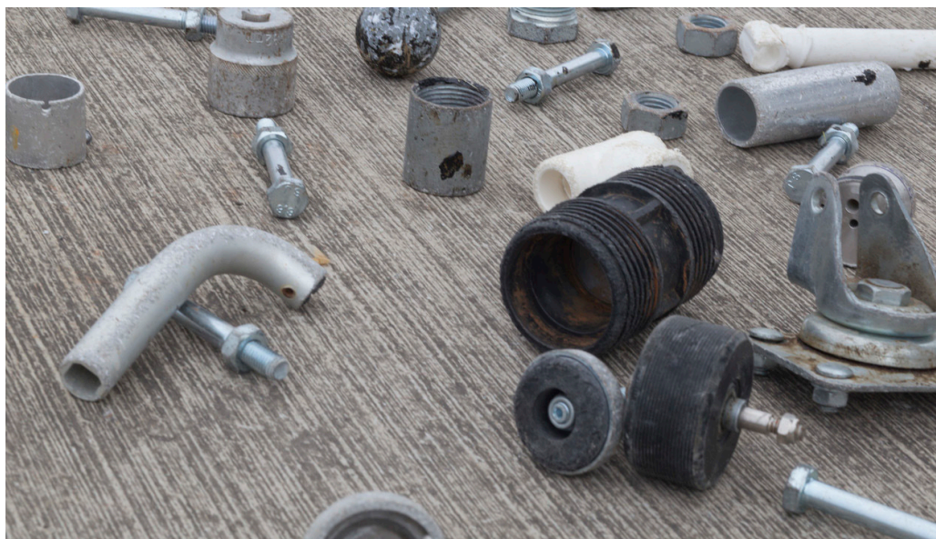
Fot.3. Przykłady FOD znalezione w obrębie dróg kołowania i płyt postojowych, źródło: ze zbiorów autora
