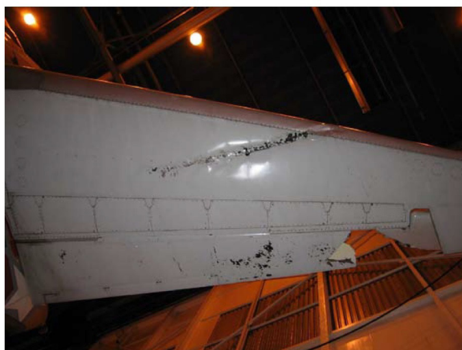
Fot.1. Uszkodzenia lewego statecznika poziomego i steru wysokości samolotu G-DOCT, źródło: AAIB Bulletin 6/2007
