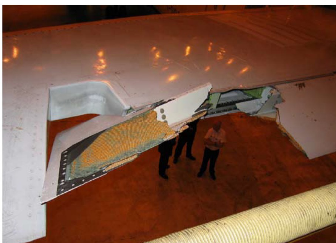
Fot.2. Uszkodzenia lewego steru wysokości samolotu G-DOCT, źródło: AAIB Bulletin 6/2007
