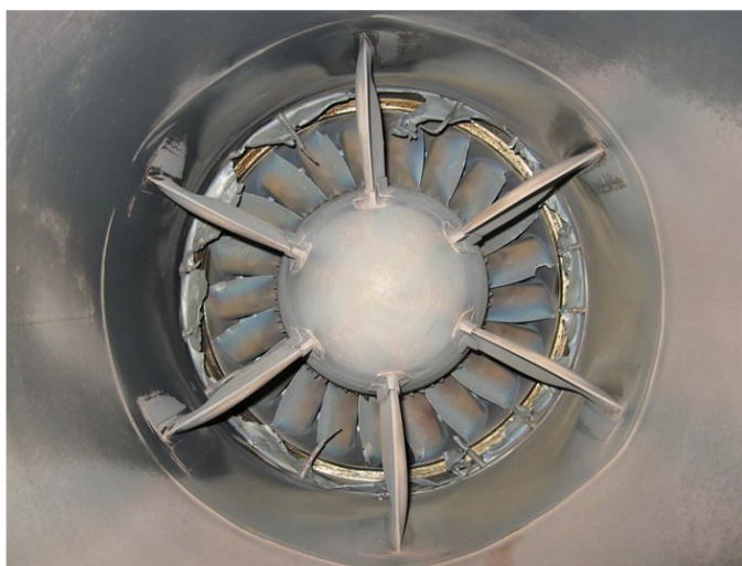
Fot.4. Uszkodzony podczas incydentu silnik nr 1, ujęcie od tyłu. Źródło: Raport C5/2010L fińskiego Accident Investigation Board
