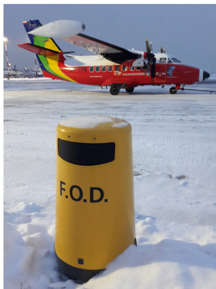
Fot.9. Pojemnik do zbierania FOD usytuowany przy płycie postojowej samolotów, źródło : Paweł Szpakowski
